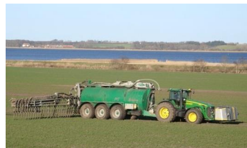
Abbildung 1: Gülleausbringung auf dem Feld mit dem System SyreN. (Quelle: www.biocover.dk )
