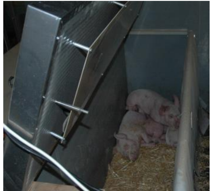
Abb. 7: Steuergerät (links) eines Ferkelnestes sowie Infrarotheizplatte (rechts) im Deckel mit Temperaturfühler in der Mitte
