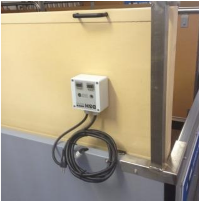
Abb. 7: Steuergerät (links) eines Ferkelnestes sowie Infrarotheizplatte (rechts) im Deckel mit Temperaturfühler in der Mitte
