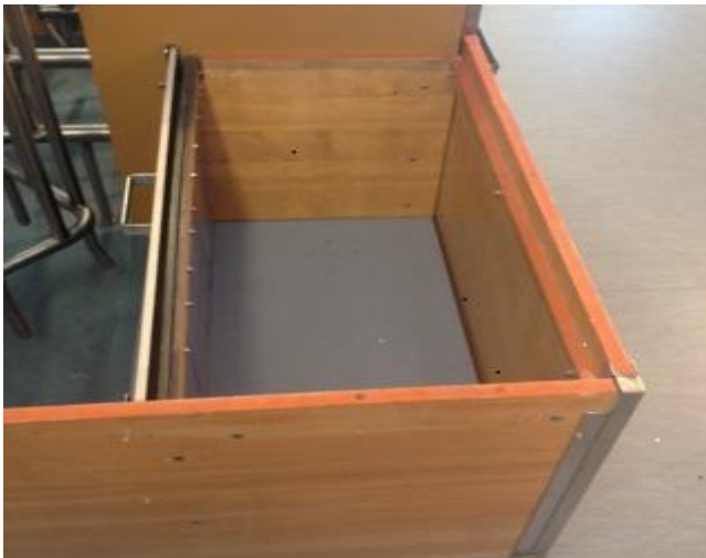
Abb 4: Kistenwände aus Holzschalplatten (links) oder hohlen Kunststoffpaneelen (rechts) isolieren ungenügend.
