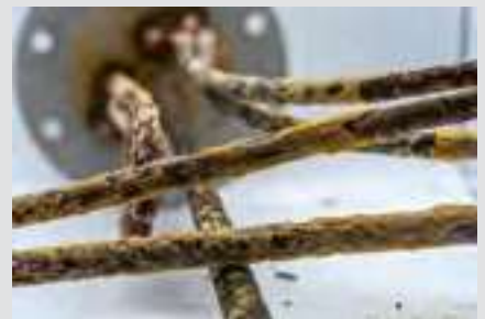
L'accumulation de calcaire (tartre) sur la résistance d'un chauffe-eau électrique dans les zones disposant d'une eau à dureté élevée diminue ses performances.
