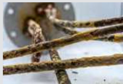
Verkalkte Boiler-Heizstäbe reduzieren die Heizleistung. Bild: Ralf Punkenhofer/Adobe Stock
